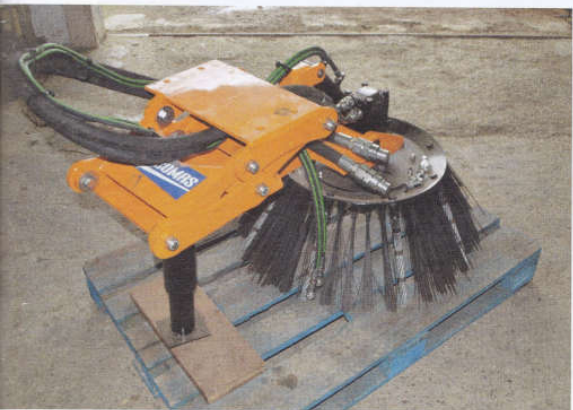
Spazzatrice e barra a dischi: due degli attrezzi con cui la ditta fa gestione di strade e banchine
