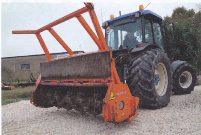
Trincia forestale Agrimaster, per la pulizia del sottobosco e la distruzione di siepi o giovani frutteti
